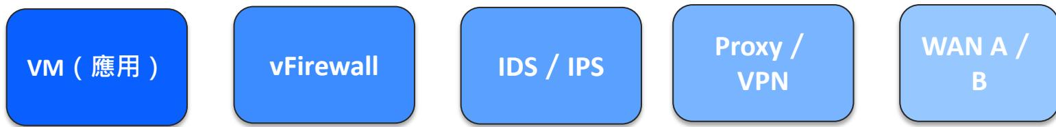
VM (應用) 透過 vFirewall、IDS / IPS、Proxy / VPN 等虛擬網路功能串接後，再由 WAN A / B 對外。每個節點可套用對應的 Security Policy 與 Log，形成最小權限、可稽核且易於調整的 Service Chain。
